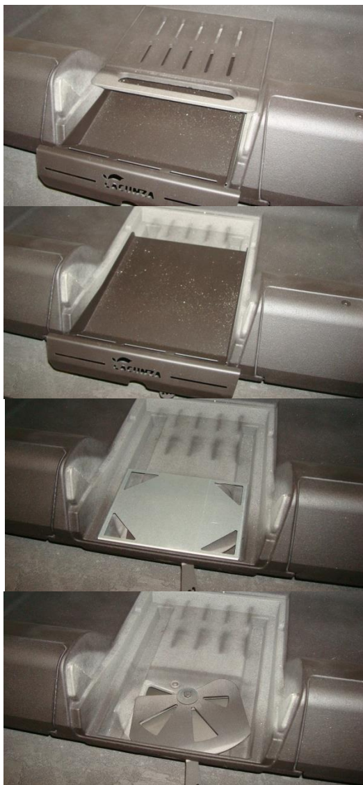
Figura n°23 - Secuencia de desmontaje de piezas para acceder a limpieza
