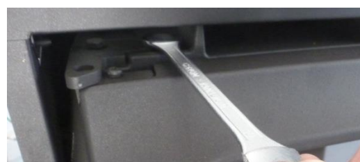
Figura n°9 - Aflojando el soporte de la puerta con llave fija de 10
