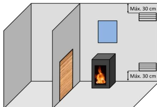
Figura nº5 - Esquema orientativo para rejillas de ventilación
