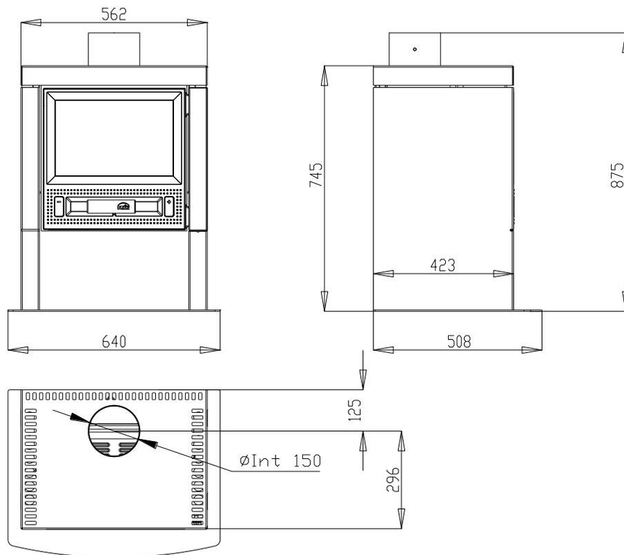
*Figura n°1- Dimensiones en mm del aparato ES-100*
