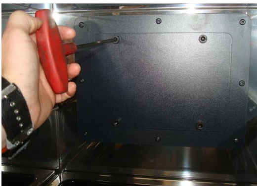
Figura n°15 - Acceso a los tornillos para retirar la tapa de la escotilla
