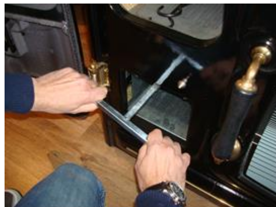
Figura nº14 - Movimiento para subir o bajar la posición de la parrilla
