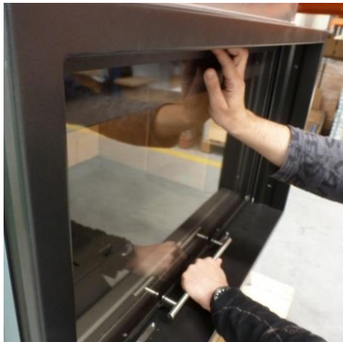
Figura n°31 - Sujetar el tirador con una de las manos mientras que con la otra tiramos de la puerta hacia fuera.
